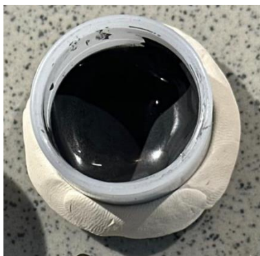
Сурет - 7 – Қалыпқа құйылған геополимер
